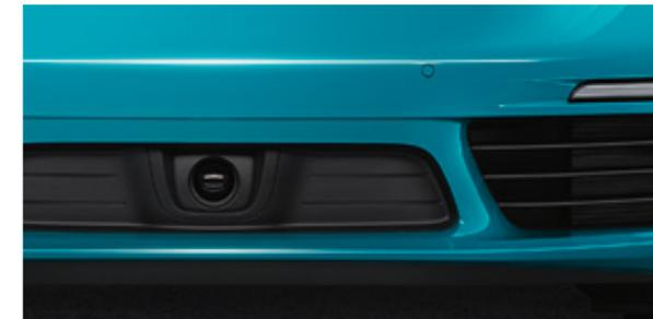
Sistema adattivo di regolazione della velocità
